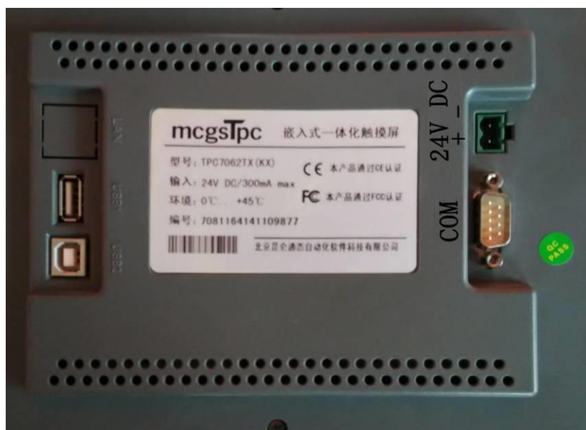
图 5-3 显示屏背面接线图
